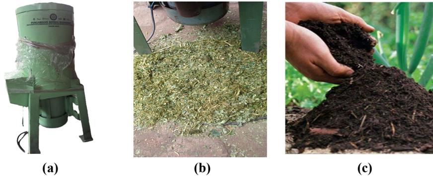
**Gambar 2. Proses pembuatan kompos (a) mesin perajang, (b) daun yang sudah dirajang (c) pupuk organik**
