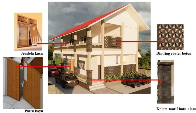
Gambar 9. Detail Material Bangunan Rumah Tahfidz
