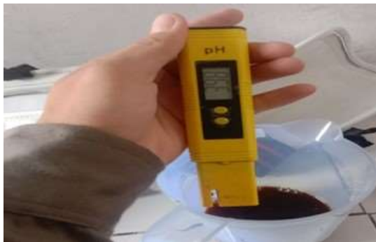
Gambar 4. Pengecekan pH Sampel Bakterisida
