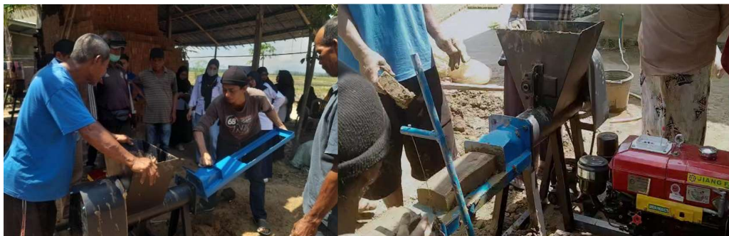
Gambar 11. Pembuatan Batu Bata Merah dengan Menggunakan Mesin Pencetak
