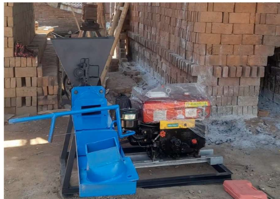
Gambar 10. Mesin Pencetak Batu Bata Merah
