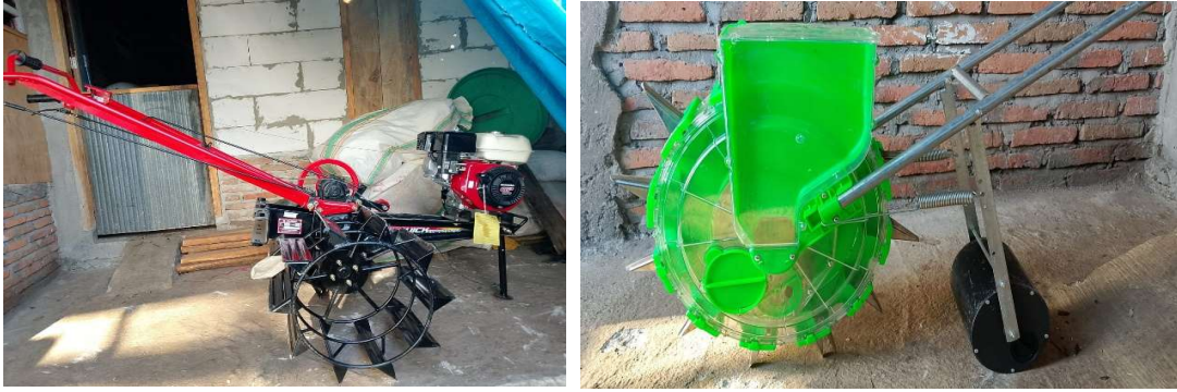
Gambar 5. Mesin traktor (kiri) dan Alat penanaman benih jagung (kanan) yang telah diterapkan kepada mitra
