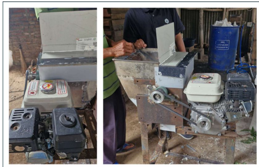
Gambar 4. Mesin Pamarut Singkong Baru
