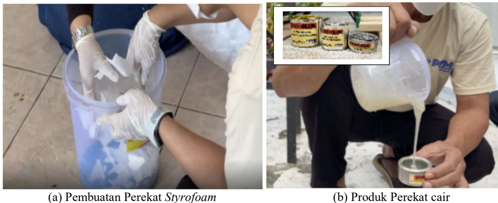
Gambar 3. Kegiatan Praktik Pembuatan Perekat Berbasis Styrofoam: pembuatan perekat cair (a), produk perekat berbasis styrofoam (b)
