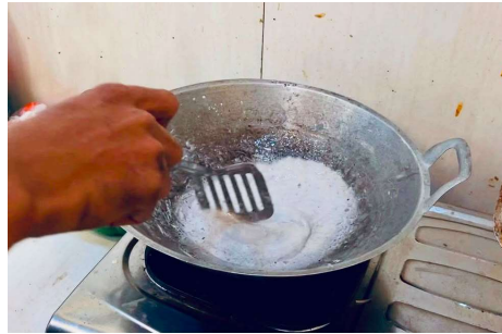
Gambar 6. Proses pembuatan lem tepung tapioka
