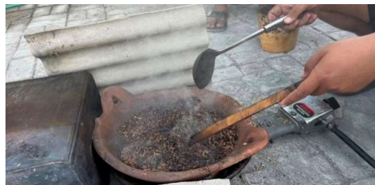
Gambar 4. Proses karbonasi sekam padi
