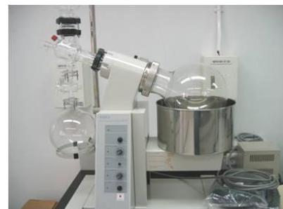
Gambar 3.3 Alat Destilasi vakum Destilasi Uap, destilasi uap dilakukan untuk memisahkan komponen campuran pada temperatur lebih rendah dari titik didih normalnya. Dengan cara ini pemisahan dapat berlangsung tanpa merusak komponen-komponen yang akan dipisahkan. Ada dua cara melakukan destilasi uap. Yang pertama dengan menghembuskan uap secara kontinu diatas campuran yang sedang diuapkan. Cara kedua dengan cara memdidihkan senyawa yang dipisahkan bersamaan dengan pelarutnya.
