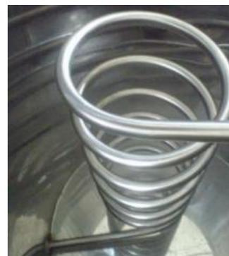
Gambar 4.5 pipa fluida dalam tabung kondensor
