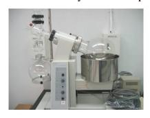
Gambar 3.3 Alat Destilasi vakum Destilasi Uap, destilasi uap dilakukan untuk memisahkan komponen campuran pada temperatur lebih rendah dari titik didih normalnya. Dengan cara ini pemisahan dapat brlangsung tanpa merusak komponen-komponen yangakan dipisahkan. Ada dua cara melakukan destilasi uap. Yang pertama dengan menghembuskan uap secara kontinu diatas campuran yang sedang diuapkan. Cara kedua dengan cara memdidihkan senyawa yang dipisahkan bersamaan dengan pelarutnya.
