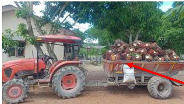
**Gambar 2. Traktor (*Infield*) Alat Angkut TBS & Brondolan**
