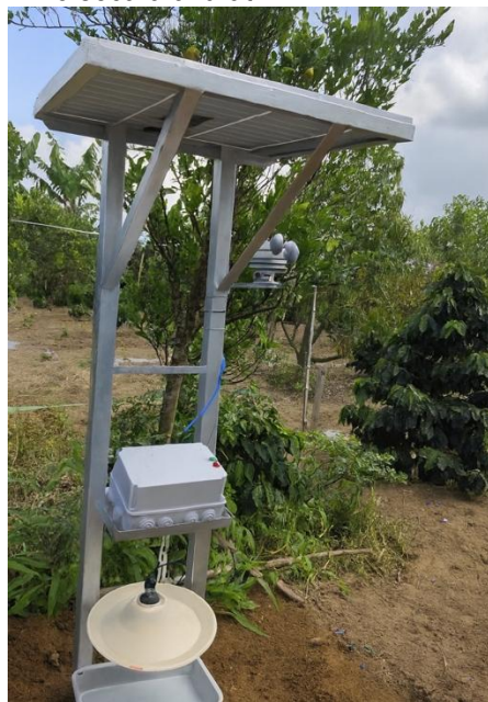
Gambar 6 Prototipe AWS di lapangan
